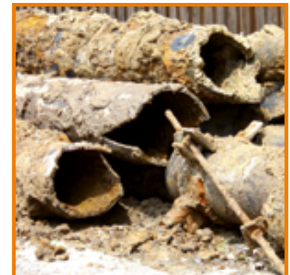
Ausgetauschte, alte Leitungsrohre. Darum ist Leitungswasser u.a. mit Vorsicht zu genießen.
